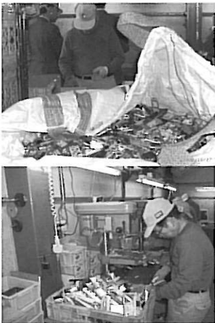
手解体による携帯電話機の分解・分別
