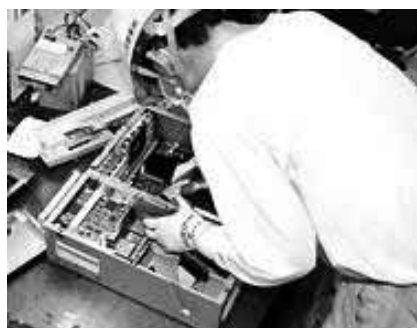
パソコンの解体作業
